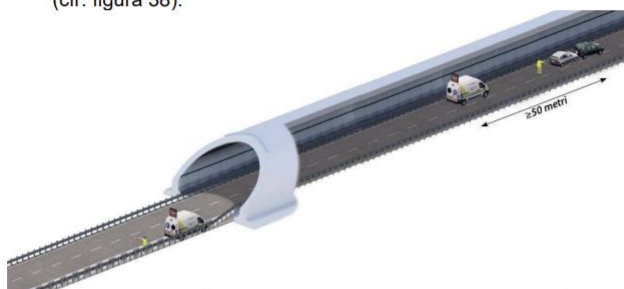
Figura 38: Evento improvviso/direttamente rilevato in galleria – Primo intervento Viabilità – Comb. B
