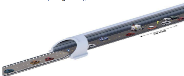
Figura 33: Evento improvviso/direttamente rilevato in galleria - Primo intervento Viabilità – Comb. A
