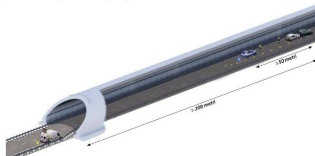
Figura 42: Evento noto/segnalato rilevato in galleria in corsia di transito - Primo intervento Polizia Stradale- Fase II
